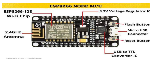
Fig 2 IoT Module (ESP 8266-12E NODE MCU)
